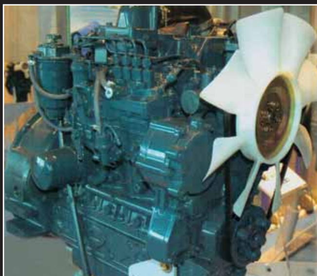
Il V3800DI-T-E3B è un propulsore a iniezione diretta con quattro valvole per cilindro da 99 CV/ The V3800DI-T-E3B engine uses four valves per cylinder with indirect injection to produce 99 HP
