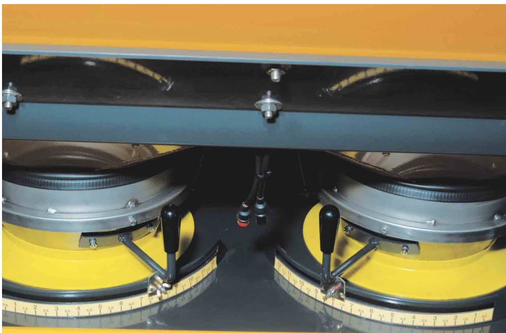
Leve di regolazione indipendenti che consentono di posizionare il punto di caduta del fertilizzante sui dischi distributori garantendo conseguentemente l'ampiezza della gittata di distribuzione/ Regulation levers adjusting fertilizer falling point on the distributor disk for the width of distribution throw
