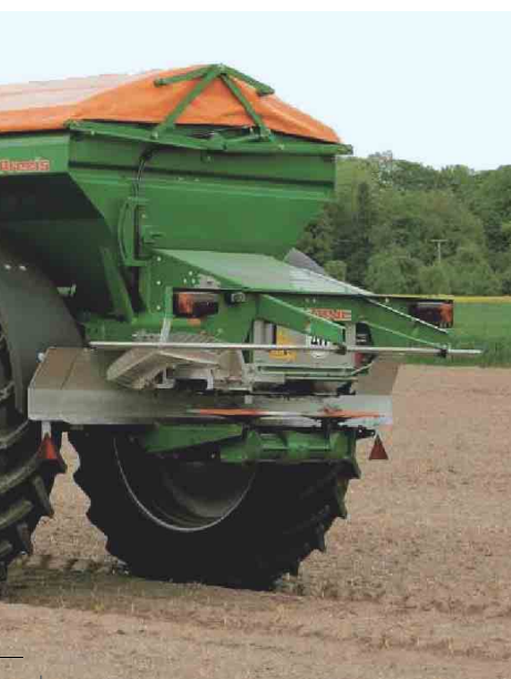
Spandiconcime centrifugo a due dischi trainato caratterizzato da una elevata capacità di lavoro/ Two-disk centrifugal fertiliser spreader with high work capacity
