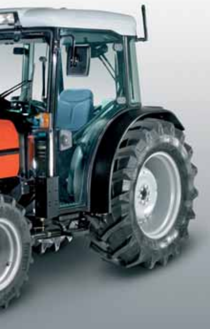
L'Iron 3 210 di Same è dotato di motore Deutz Euro III Common Rail a regolazione elettronica, compatibile al 100% con l'utilizzo di biodiesel, cambio Powershift e Sequential Drive System, che consente di memorizzare le impostazioni per le operazioni ripetitive/ The Iron 3 210 by Same mounts a Deutz Euro III Common Rail engine with electronic management, 100% compatible with biodiesel, a Powershift gearbox and SDS (Sequential Drive System) for memorizing the performance of repeated operations and repeating them
