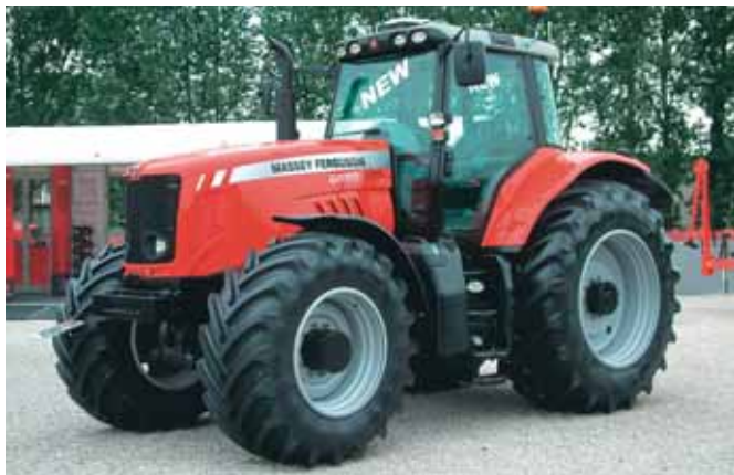
Il nuovo MF 6499 con cofano basculante, motore Tier III Common Rail a 4 valvole da 230 CV e sollevatore anteriore integrato nella struttura del trattore/ The new MF 6499 with pivoting hood, 230 HP Tier III Common Rail 4-valve engine and incorporated front lift
